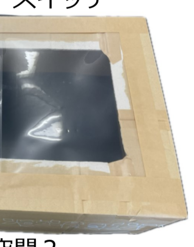
図11 自作実験空間2 (500(奥行)×720(幅)×260(高さ)mmのダンボール全体に塩化ビニル樹脂を貼り、上部にA3クリアファイルの窓をつけた)
